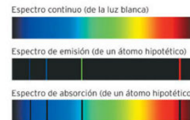
Figura 2.12. Espectro de emisión de hidrógeno. La luz visible incluye todos los valores de energía: rojo, azul, verde, etcétera. La luz que emite o absorbe el hidrógeno solo presenta algunos colores, que equivalen a la energía de los niveles electrónicos.
