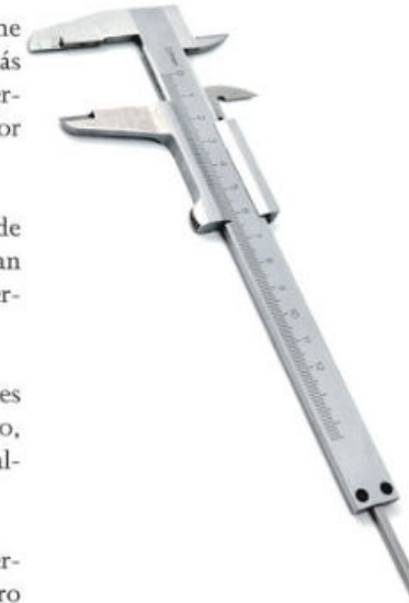
Figura 1.14. El vernier es un instrumento de medición, se utiliza para realizar mediciones de longitud de gran precisión. Con él puedes medir una tuerca, una semilla de ajonjolí o el espesor de tus uñas.
