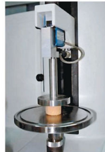
Figura 1.9. El texturómetro es utilizado en la industria galletera para dar la consistencia necesaria a las galletas, de manera que no se quiebren con facilidad.
