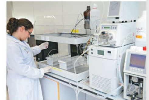
Figura 1.35. Los cromatógrafos de líquidos de alta resolución son aparatos que sirven para determinar la composición de una muestra problema, así como la cantidad de cada componente en la mezcla; son utilizados en algunos casos para determinar la contaminación de ciertas sustancias y su cantidad en una muestra.
