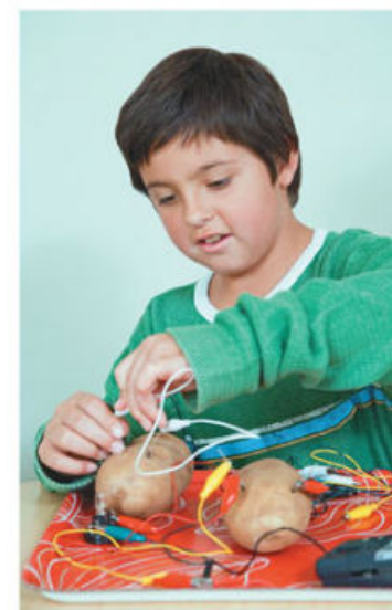
Figura 4.23. Una pila con una papa y láminas de cobre y zinc.
