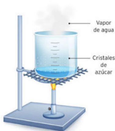
Figura 2.4. La evaporación es un método físico útil para separar una mezcla de agua y azúcar.
