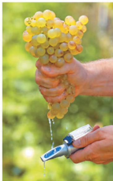
Figura 1.17. El refractómetro es un aparato que mide los sólidos totales que están disueltos en una sustancia. Con esta información podemos determinar el dulzor de las mismas.
