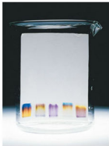
Figura 1.29. Una cromatoplaqueta muestra los componentes de una mezcla después de la separación.
