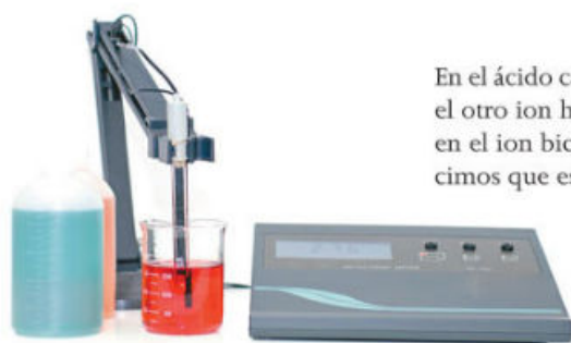
Figura 4.5. El medidor de pH nos dice la cantidad de iones hidrógeno en una sustancia.
